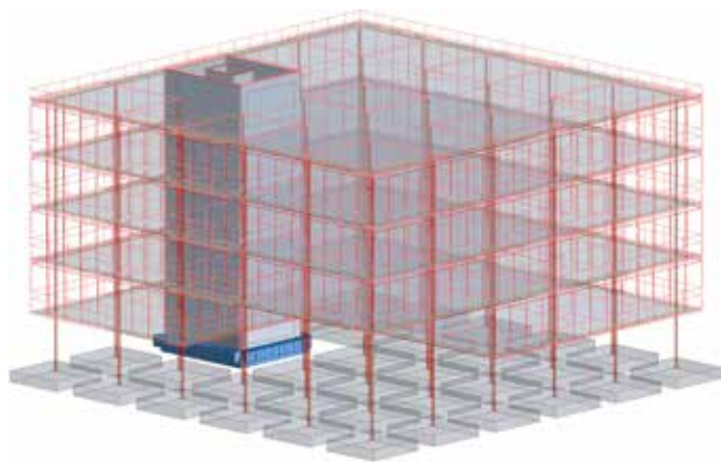
Rys. 5. Zaimportowany model analityczny do programu Robot
